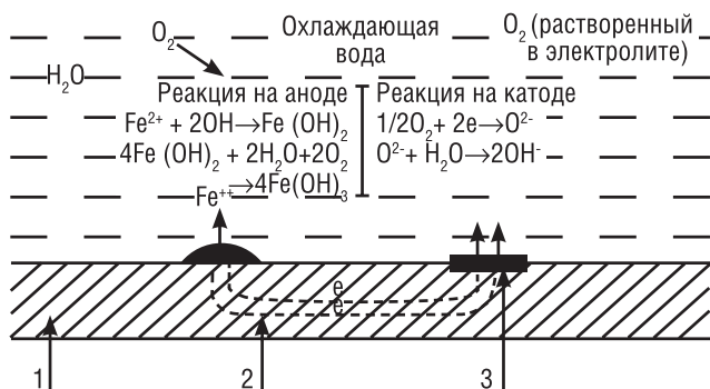
Рис. 1.24. Механизм электрохимической коррозии в системе «металл–воздух–вода»:
